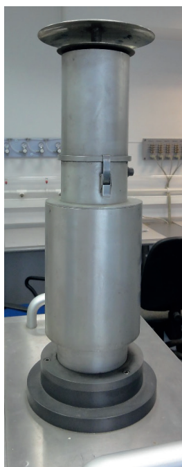
Rysunek 8.1-2. Schemat głowicy poboru dla pyłu PM10 i PM2,5 dla przepływu 2,3 \text{ m}^3/\text{h} . Źródło: PN-EN 12341:2014.
